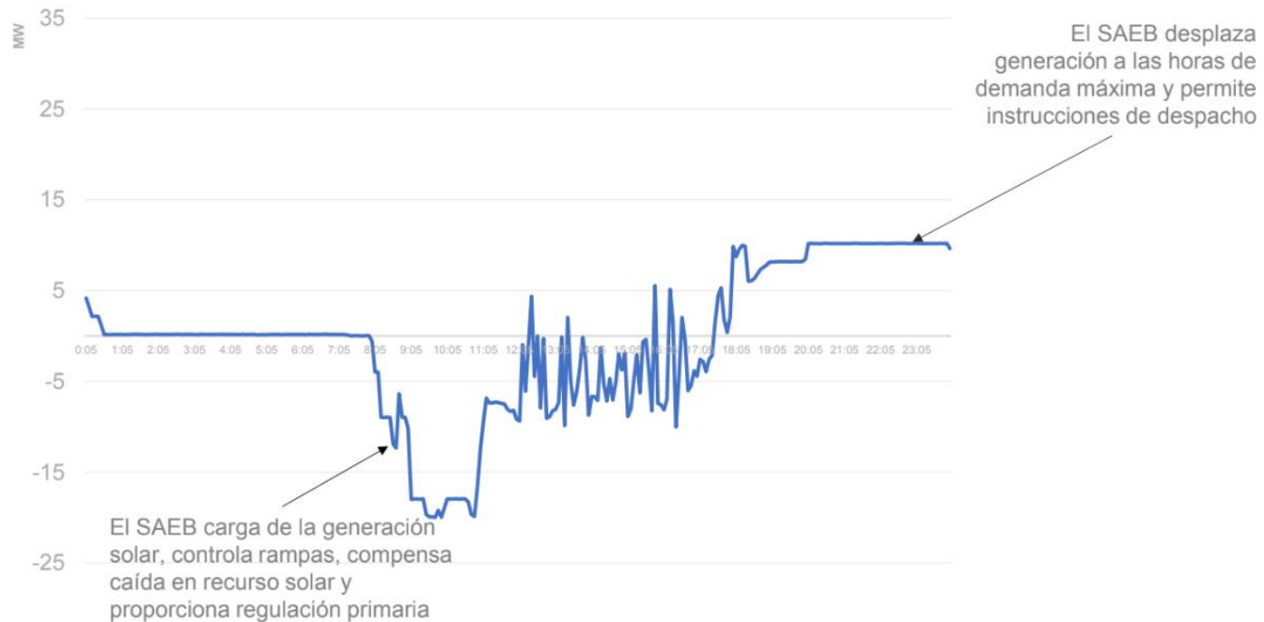
Figura 26. ¿Qué hace la batería? Fuente: Invenergy (19 de noviembre de 2024). El futuro del almacenamiento de energía en México, México: Invenergy.
